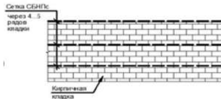
Рис.4.2 схема армирование кладки базальтовой геосеткой
